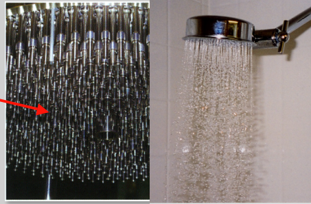
Chamber backplane comprises 516 injecteurs
