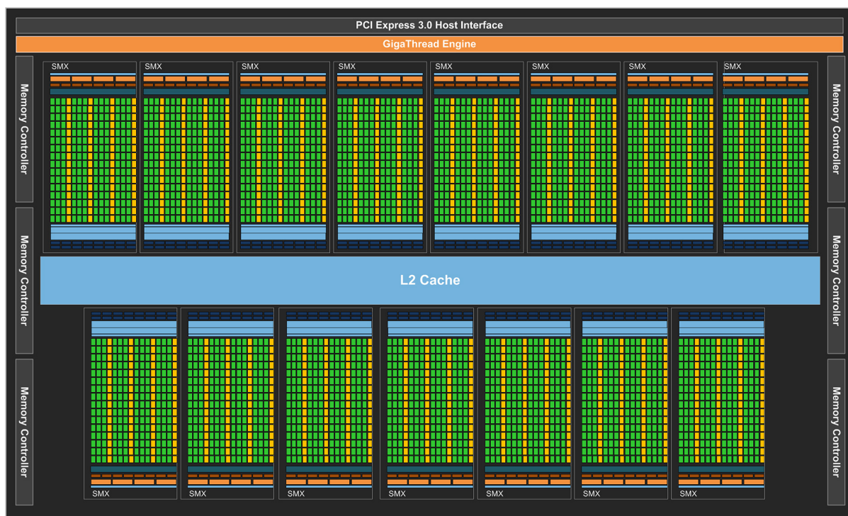
FIG. 12 – Répartition des unités de calcul dans les multiprocesseurs de flux (SMX) d'un GPU de type GK110
