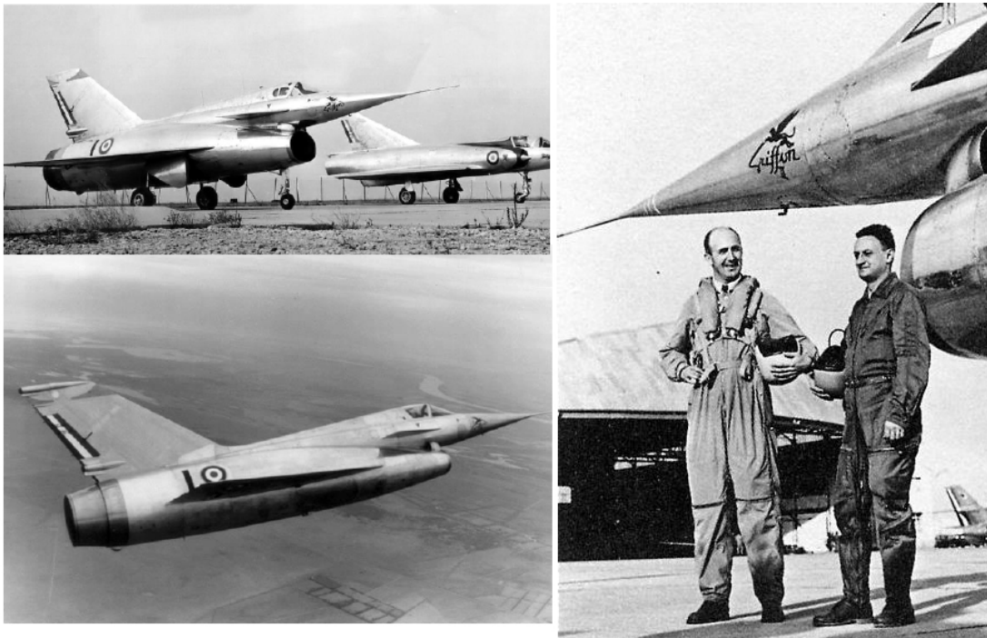
FIG. 1.4 - Le Griffon II avec ses pilotes, Chalard et Turcat. Le diamètre du système propulsif est d'environ 1,5 m (Crédits : Docavia n° 28).
