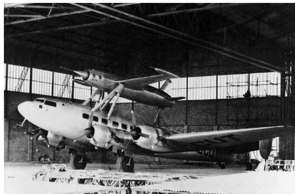
FIG. 1.3 - Le Leduc 010 sur le Languedoc 31. Ce dernier permettait de propulser le prototype à une vitesse suffisante pour mettre en marche le statoréacteur.
